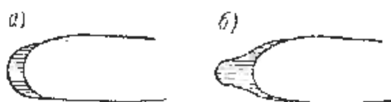
Рис. 83. Отложения профильного (а) и пикообразного (б) льда
