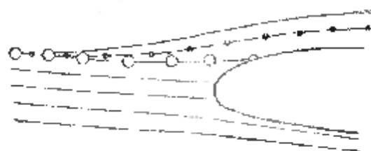
Рис. 82. Обтекание крыла воздушным потоком, в котором находятся водные капли (точки — мелкие, кружки — крупные)
