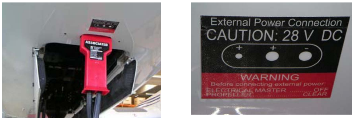
Рис. 8. Штепсельный разъём аэродромного электропитания
