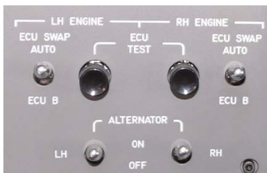
Рис. 4. Внешний вид выключателей генераторов, блоков управления двигателями (ECU) и кнопок их тестирования
