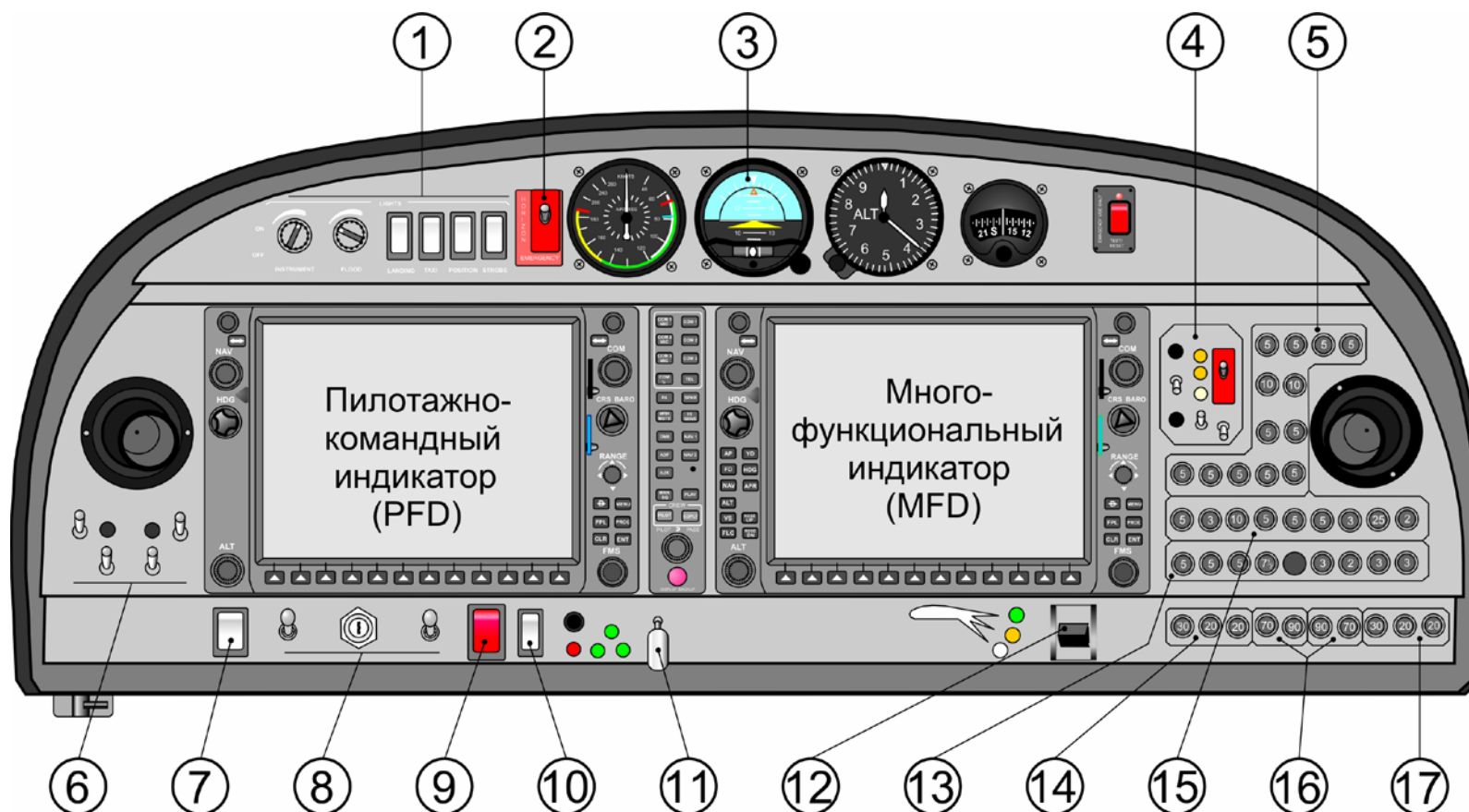
Рис. 2. Приборная доска самолёта DA 42:
