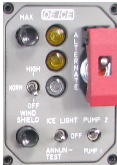
Рис. 20. Пульт управления противообледенительной системой
