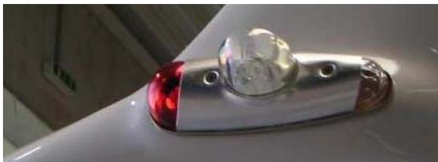
Рис. 17. Внешний вид левого комбинированного блока аэронавигационных и проблесковых огней
