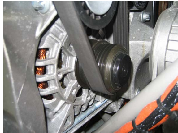
Рис. 3. Механический привод генератора
