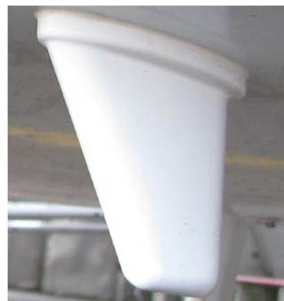
Рис. 5.1. Внешний вид антенны дальномера DME
