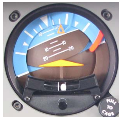
Рис. 2.19. Внешний вид резервного авиагоризонта
