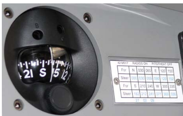
Рис. 2.21. Внешний вид резервного магнитного компаса и таблицы поправок
