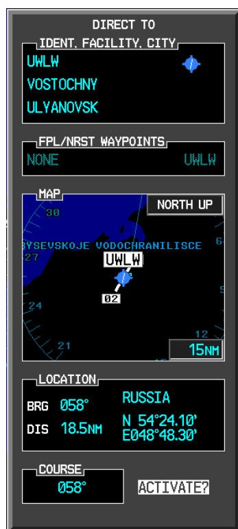
Рис. 7.9. Диалоговое окно режима «DIRECT TO» на дисплее MFD
