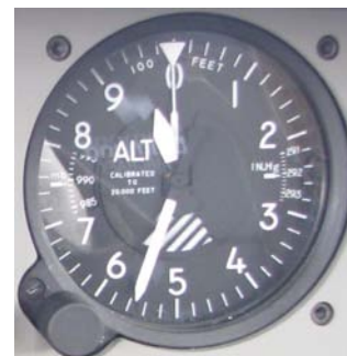
Рис. 2.10. Внешний вид барометрического высотомера
