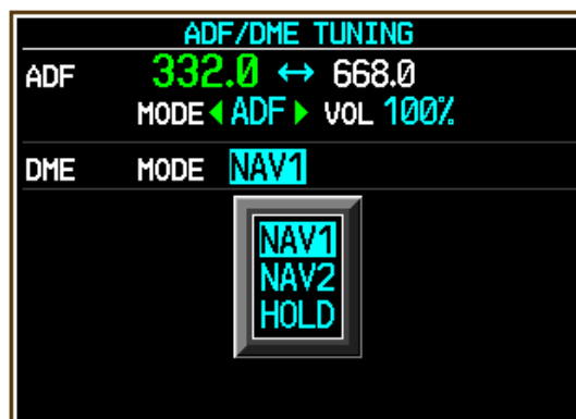
Рис. 5.3. Информационное окно для настройки дальномера DME
