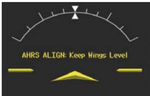
Рис. 2.17. Сообщение экипажу в режиме выставки курсовертикали
