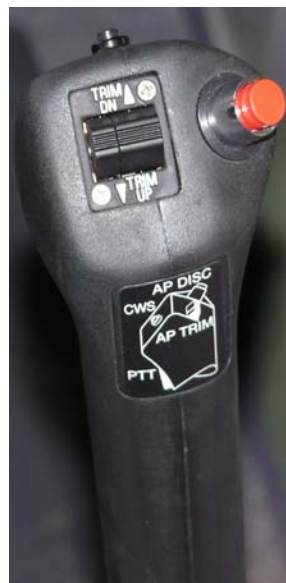
Рис. 3.4. Внешний вид ручки управления 1-го пилота
