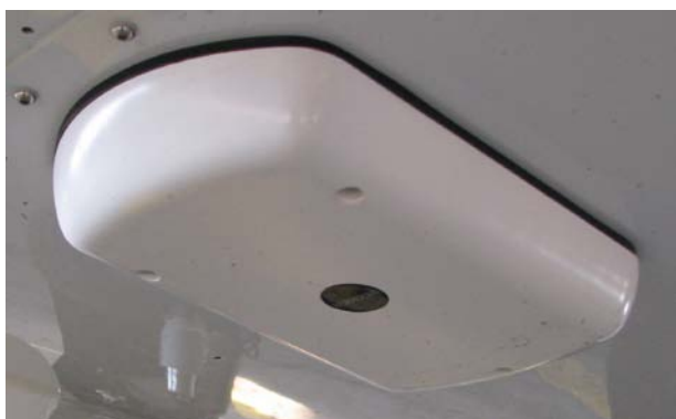
Рис. 3.1. Внешний вид блока антенн АРК (направление полёта справа)
