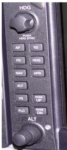
Рис. 3.3. Панель управления системы GFC 700
