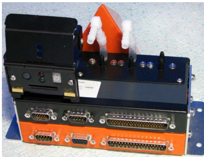
Рис. 4.2. Внешний вид модулей APIV2-002, APICAP-003 и модуля технического обслуживания APISD-001
