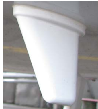
Рис. 2.20. Антенна ответчика
