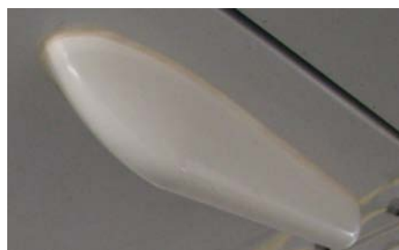
Рис. 4.1. Внешний вид антенны маркерного приёмника (направление полёта слева)
