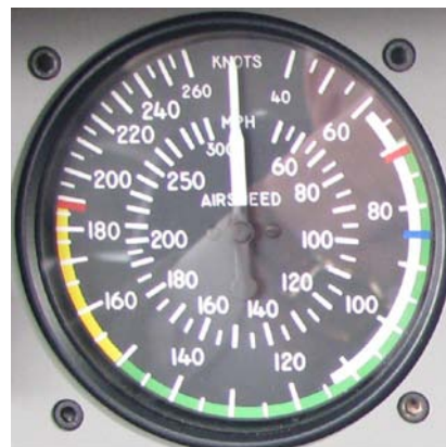
Рис. 2.5. Внешний вид указателя воздушной скорости
