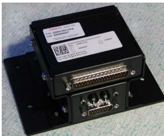
Рис. 4.1. Внешний вид модуля электропитания APIPWR-001 и модуля преобразования параметров авиадвигателей i2050-002 EPA
