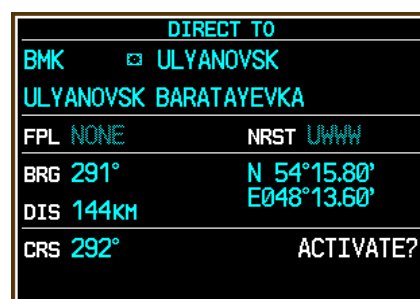
Рис. 7.10. Диалоговое окно режима «DIRECT TO» на дисплее PFD
