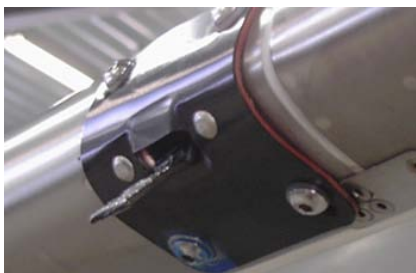
Рис. 2.23. Внешний вид датчика сваливания
