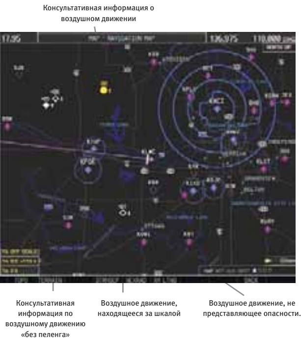
Рисунок 10-14. Воздушное движение от системы консультативной информации о воздушном движении (TAS) на навигационной карте.
