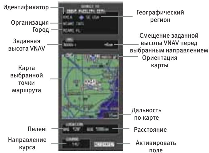
Рисунок 7-2. Окно Direct-to в MFD
