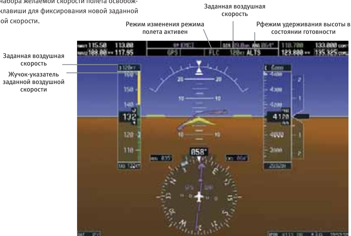
Рис. 6-9 Режим изменения эшелона полета
