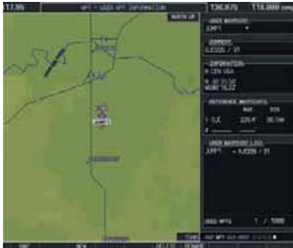
Рисунок 8-1 Информационная страница, определяемых пользователем точек маршрута (WPT)
