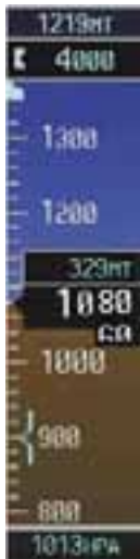
Рисунок 2-9 Высотомер (метрический)
