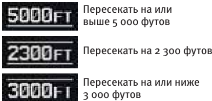
Рисунок 1-9 Ограничения высот
