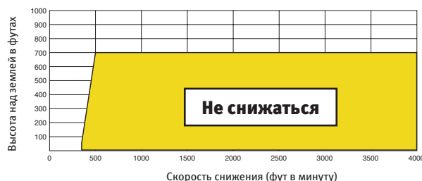
Рисунок 10-23. Отрицательная скорость набора высоты
