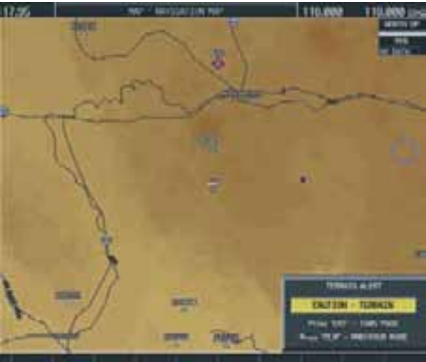
Рисунок 10-24. Всплывающие сообщения системы TAWS
