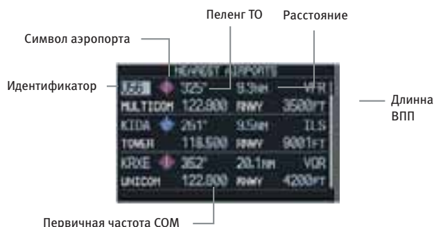
Рисунок 7-59. Окно ближайших аэропортов (Nearest Airports)
