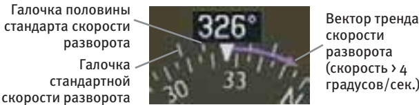
Рисунок 2-19 Индикатор скорости разворота и вектор тренда
