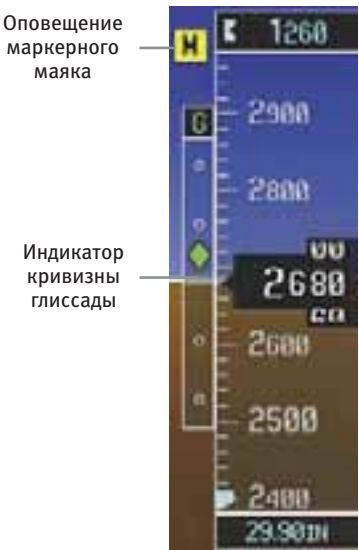
Рисунок 2-13 Индикатор кривизны глиссады
