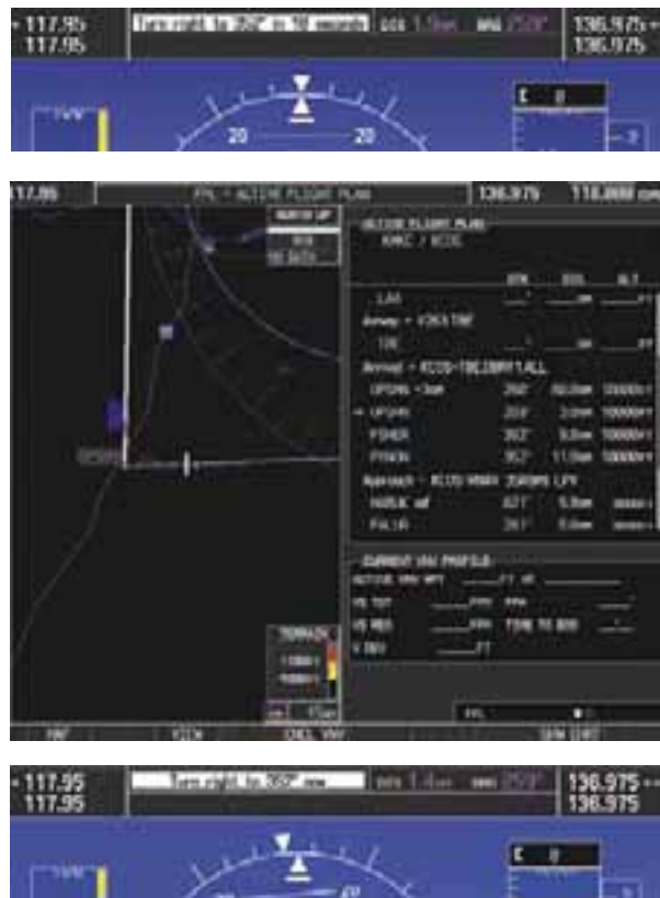
Рисунок 7-40. Разворот для захвата участка OPSHN – FSHER.
