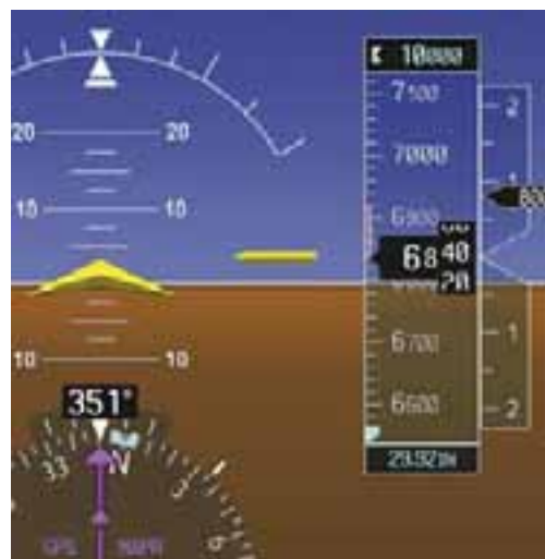
Рисунок 7-48. Процедура ухода на второй круг активна
