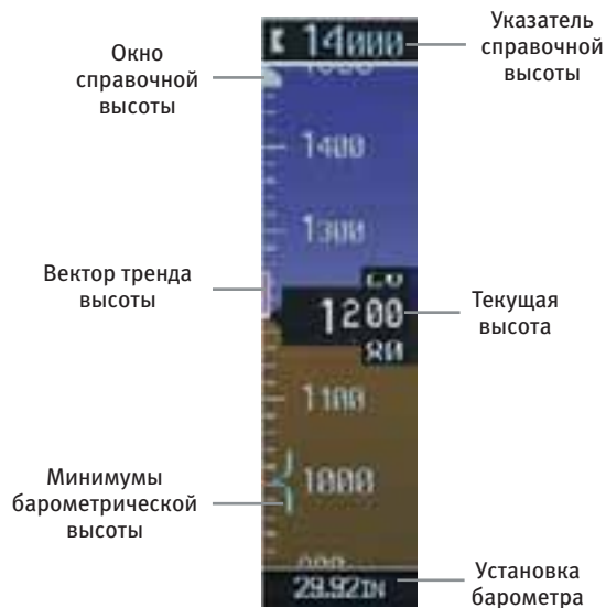
Рисунок 2-7 Высотомер
