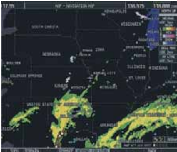
Рисунок 10-7. Отображение метеорологической информации NEXRAD на странице навигационной карты.
