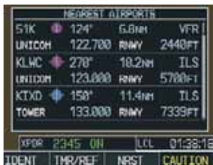
Рисунок 4-10 Окно ближайших аэропортов (PDF)
