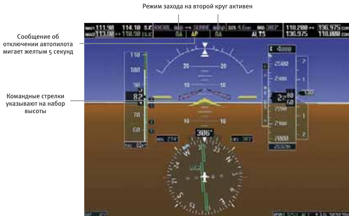
Рис. 6-19 Режим захода на второй круг (GA)
